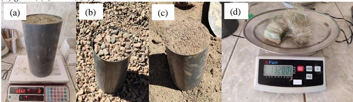
Seguidamente, se mezclan en la probeta cilíndrica como se observa en la Figura 4(a), obteniendo mezclas en dichas probetas cilíndricas (Figura 4b) y las baldosas (Figura 4c) a ensayar a un tiempo de 28 días, donde se alcanzará a comparar las cargas a flexión, resistencia a la compresión y a la tracción indirecta.
