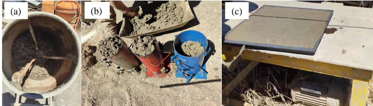
En cuanto al resultado de la dosificación del concreto que se registró para comparar muestras con y sin fibra PET, se detalla a continuación en la Tabla 3. Estas muestras se desmoldaron a las 24 horas de su elaboración y se curó con agua durante los 28 días como se muestra en las figuras 5<sup>a</sup>, 5b y 5c.
