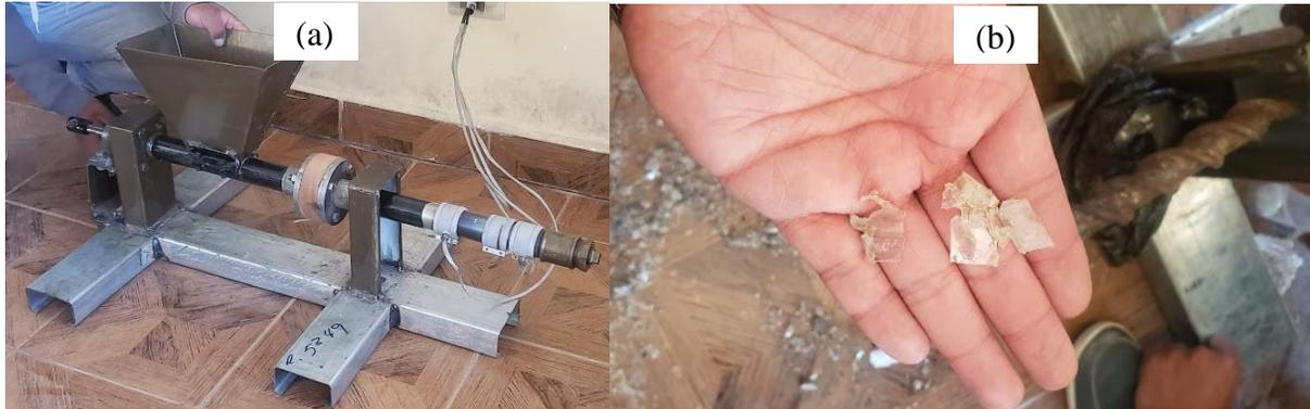
En un principio de la investigación, se tenía solo una banda térmica, pero el PET triturado no se fundía con el calor, posteriormente se fue aumentando las bandas térmicas hasta llegar a 3 piezas, que en este caso se lo efectuó de forma empírica, teniendo en cuenta el rendimiento el flujo de material que salía del proceso, en nuestro caso para 48 rpm obteníamos 8,43 kg/hr, obteniendo la temperatura promedio del material extruido como se observa en la Tabla 1.
