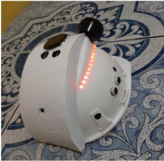
Figura 8. Casco inteligente para seguridad industrial desarrollado por la Universidad Técnica Estatal de Quevedo
